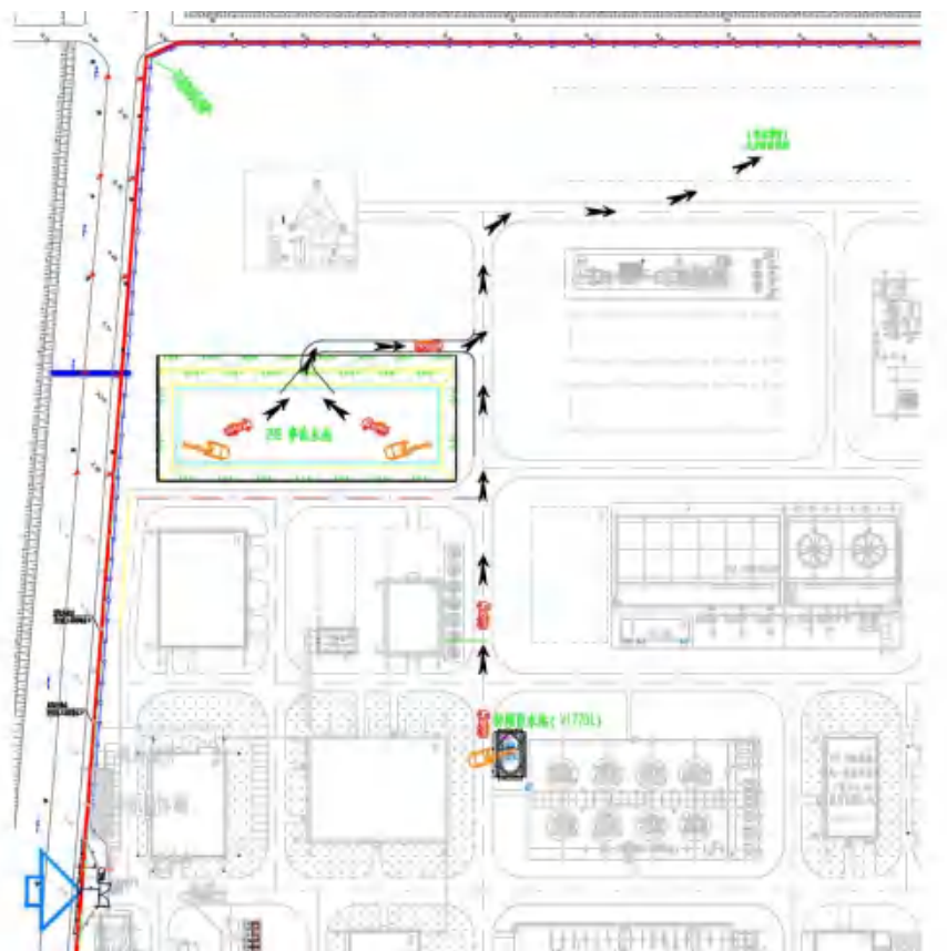
图 2.2-3 基础施工平面布置图
